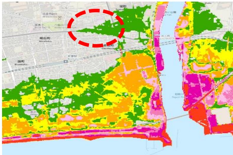
Mw 8.85に調整した相模トラフ海溝型地震の数値計算結果
